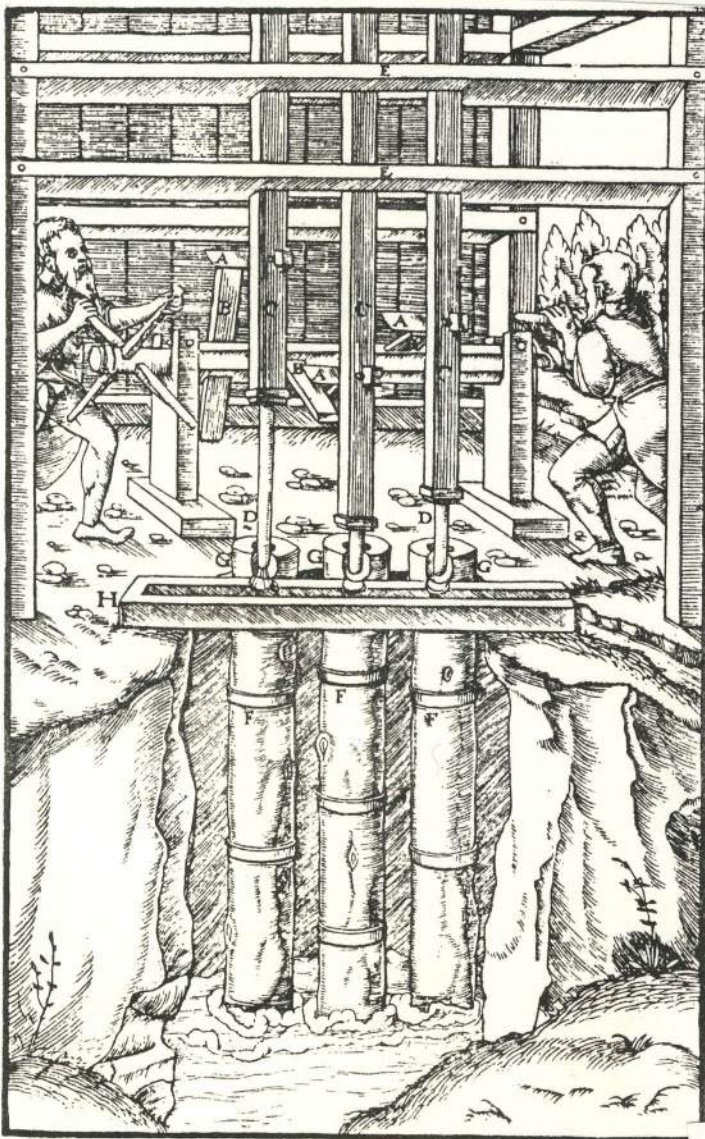
■ BATTERIA DI POMPE AZIONATE DA UN SISTEMA DI CANNE
