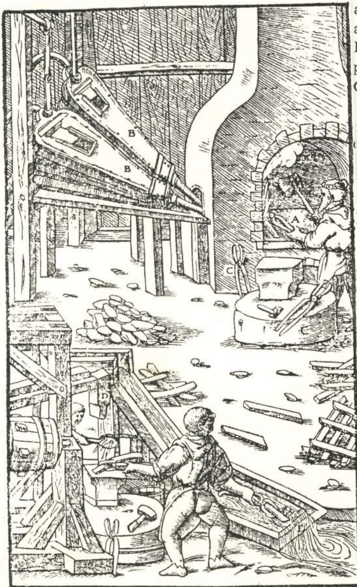
■ FUCINA E MAGLIO PER LA FABBRICAZIONE DELLE ATTREZZATURE E DEGLI UTENSILI NECESSARI ALLA MINIERA
